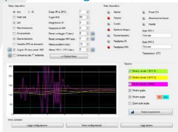
Possibilità di impostare le soglie della MW, IR1 ed IR2 a seconda delle condizioni dell'ambiente
